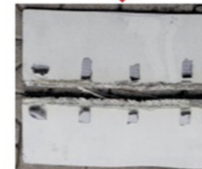
Trennung des GFK Materials nach Zündung im Bunker
