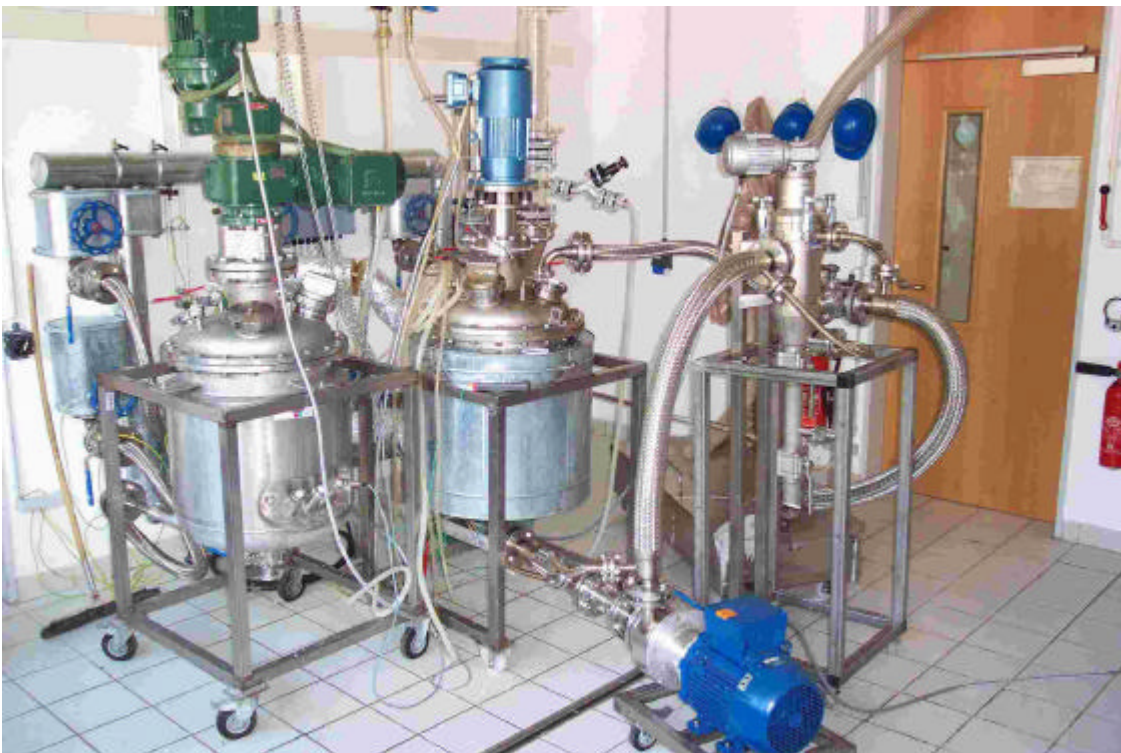
Lösereaktor, Kantenspaltfilter und Fällreaktor zum Recyceln von Kunststoffen im Explosionsgeschütztem Labor im Fraunhofer IVV.
