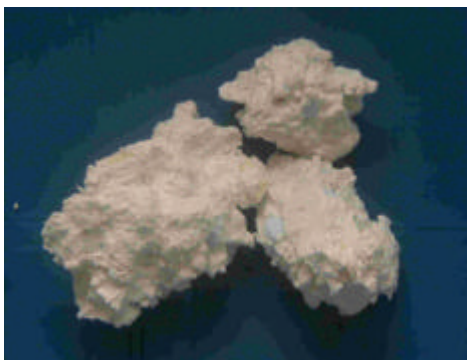
Inputmaterial gepresste Fischboxen und abgetrennte Verunreinigungen
